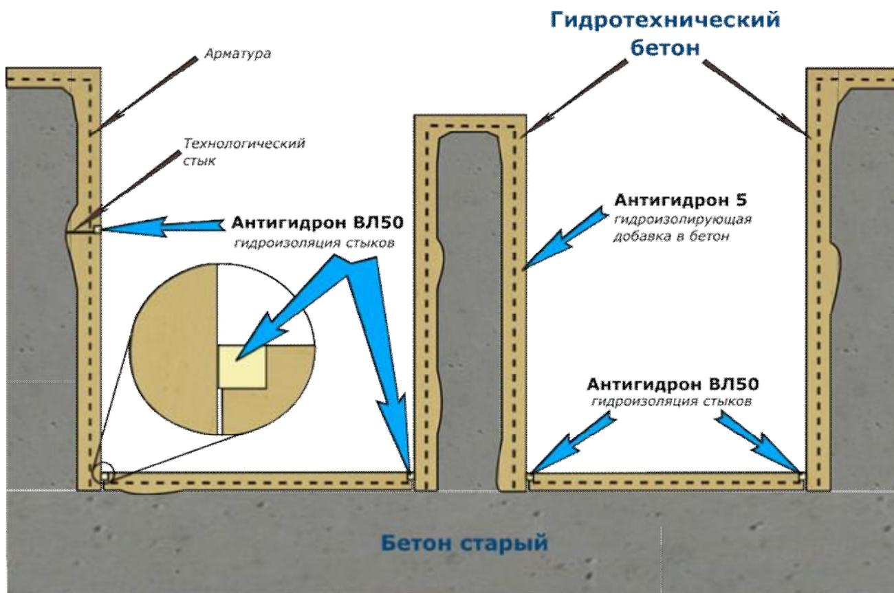
1. Гидротехнический бетон (прочность не менее В25) с водоцементным соотношением не более 0,4 с добавкой Антигидрона 5 "Жидкий гиперконцентрат" (расход - 4 л на кубометр бетонного раствора).
